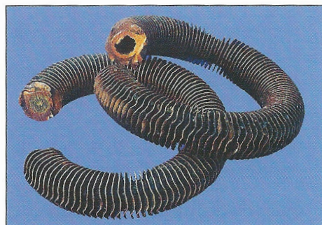
Kjølerør. Før og etter rens.
